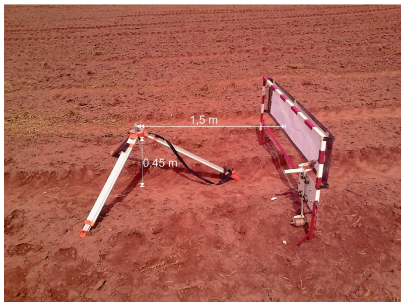
Figura 2 - Método adotado para fotografar o desenho feito pelo rugosímetro
