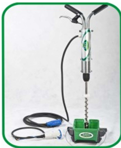
Figura 1 - Imagem do amostrador elétrico com rosca helicoidal (SACI S40, acionado por bateria).
